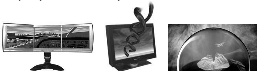
Fig. 3. Algunos ejemplos de pantallas mejor adaptadas al sistema visual humano. A la izquierda la pantalla Panoram formada por tres paneles LCD, en el centro la pantalla autoestereoscópica SynthaGram, y a la derecha el monitor 3D Perspecta.
