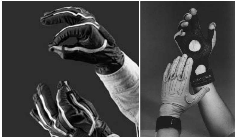
Fig. 4. Los guantes Pinch Gloves (a la izquierda) no requieren calibración y el reconocimiento de gestos es más sencillo que en el caso de guantes de datos que, como el CyberGlove (derecha) miden la flexión y abducción de los dedos.
