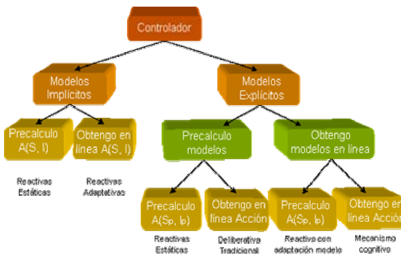
Fig. 1 Clasificación de los tipos de arquitecturas de control en robótica autónoma
