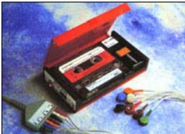
Figura 3.2: Monitor holter de principio de los años 80 con grabación en cinta magnética.
