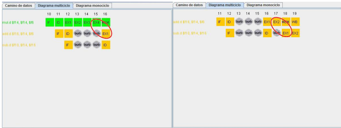
Figura 4.6. Diagrama multiciclo para el Ejemplo 1.s con adelantamiento.
