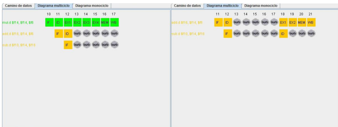
Figura 4.7. Diagrama multiciclo Ejemplo 1.s sin adelantamiento.
