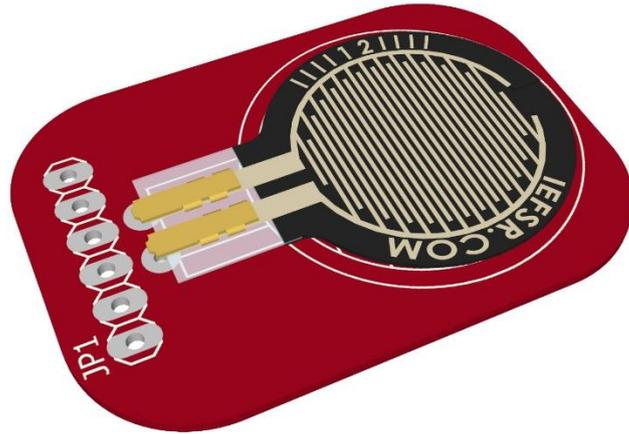
Figura 4.32: Detalle del FSR 402 Short en la PCB de la sonda.
