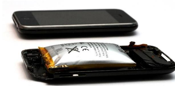
Figura 4.4: Batería hinchada por sobrecarga.
