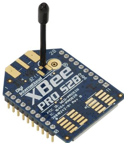
Figura 4.13: Módulo ZigBee XBee Pro de Digi International.
