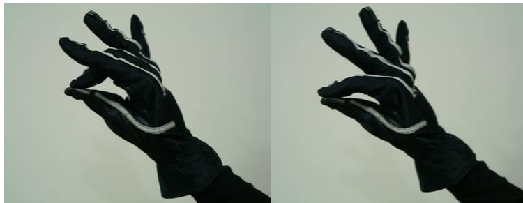
Figura 7.3 Gestos “pinch” para coger y soltar en VRPrismaker
