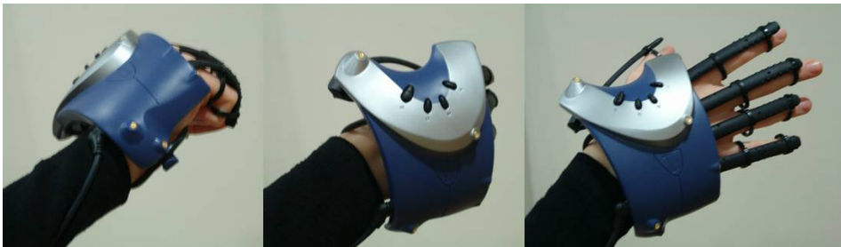
Figura 7.2 Gestos de coger, rotar y solar una pieza en TTristéreo
