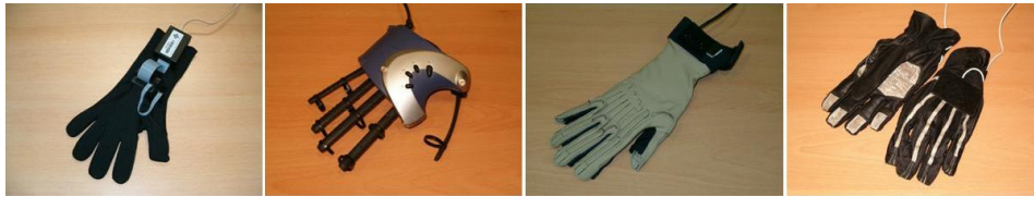
Figura 2.5 Diferentes modelos de guantes ofrecen distintas tecnologías y número de sensores.
