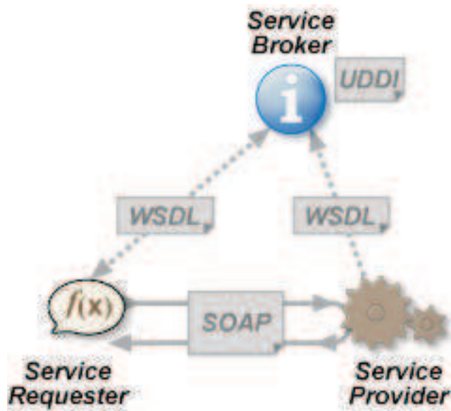
Figura 1. Diagrama de funcionamiento de los servicios Web.
